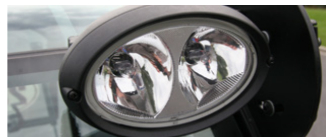
2x projecteur de travail avant à double alimentation, 1x arrière à alimentation simple
