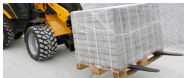
De 3450 S kan pallets van 2,0 t transporteren. Een smalle en zeer lage voorwagen optimaliseert het zicht van de bestuurder op het gereedschap.
