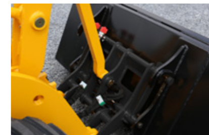
Met de gereedschapshouder „SWH“ kunnen alle opbouwgereedschappen snel aan- en afgekoppeld worden. De hydraulische vergrendeling is standaard.
