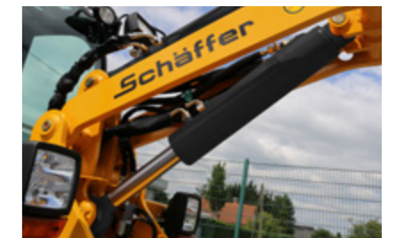
De hefcilinder werd overeenkomstig de hoge kiplast bijzonder sterk gedimensioneerd. Kogelscharnieren beschermen tegen torsie.
