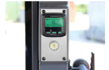
Nieuw infodisplay in de B-zuil voor het uitlaatsysteem
