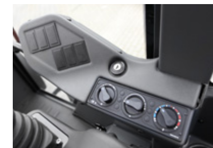
Nieuwe bedieningsconsole: gemakkelijk bereikbaar contactslot, verwarmingsregeling en optionele klimaatregeling
