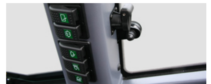
gecentraliseerd schakelaarsveld, stopcontact met gelijkstroom
