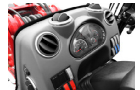
Bijkomstige, grotere ventilatieopeningen voor optimale luchtcirculatie / geoptimaliseerde schakelaars.
