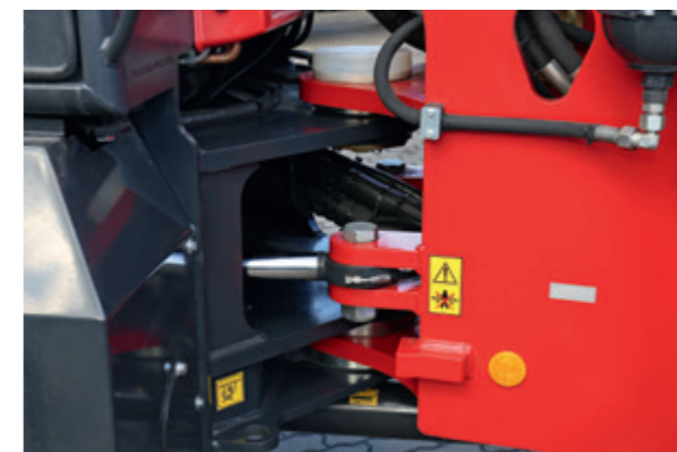
Het centraal knikstelsel is zeer sterk en onderhoudsvrij. Twee stuur cilinders zorgen voor perfecte controle.
